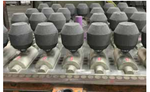
Şekil 3. En ufak temas alanını kullanan FEEDEX VAK uygulaması
