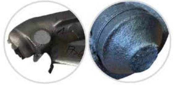
Şekil 7. Yeni nokta besleyici konsepti ile kırma sonucu - neredeyse daha fazla taşlama gerektirmeyen sağlam döküm parça
