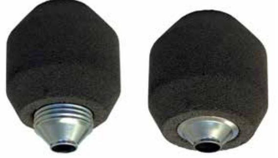
Şekil 5. Sıkıştırmadan önce ve sonra yeni besleyici konsepti - besleyici gömlek gövdesi ile döküm arasında tipik olarak 8 ila 15 mm mesafe
