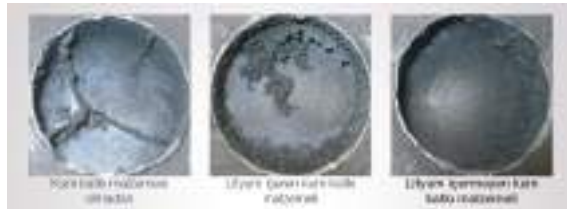
Şekil 2: M-Refrakter boya kaplı kubbe maçalar; %2 kum katkısı, GJL tipi döküm ve yaklaşık 1420 °C döküm sıcaklığı
