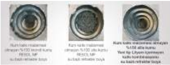
Şekil 8: Küçük çaplı basamak konik döküm; GJL tipi döküm; döküm sıcaklığı 1420°C; su bazlı refrakter boya
