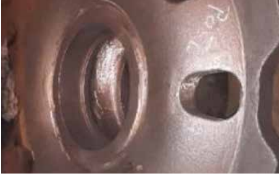
▲ Şekil 12c: Menevişleme sonrası MPI çatlama
