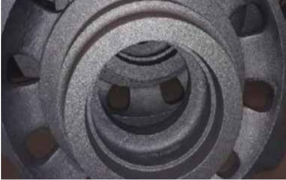
▲ Şekil 12d: Ultrasonik ve MPI kontrolleri son- rası üst derece döküm yüzeyi
