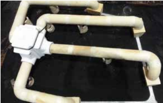
Şekil 15a: HOLLOTEX Shroud filtre kutusu takılı yolluk sistemi
