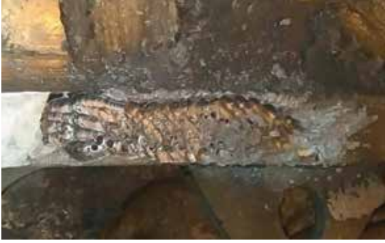
Şekil 14a: Üst yüzeydeki tipik gaz hataları
