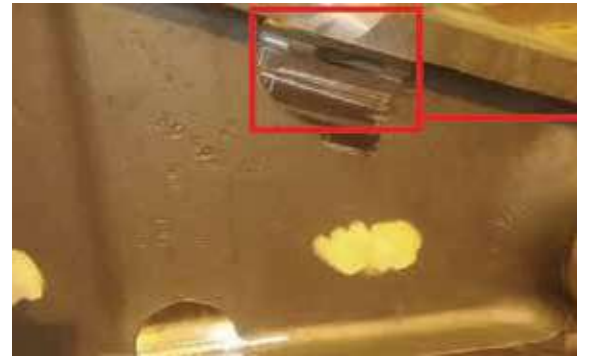
Şekil 16a: HOLLOTEX Shroud üst derece döküm yüzeyi - yolluk sistemi
