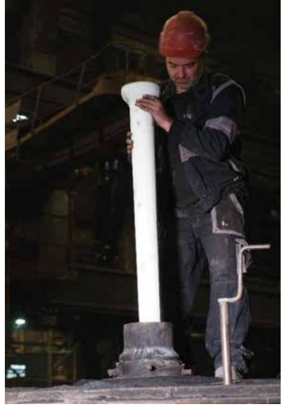
▲ Şekil 6a: Hazırlanmış kalıbın içerisine HOLLLOTEX Shroud yerleşimi
