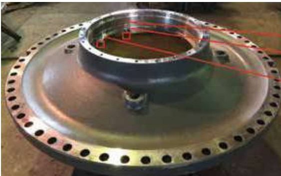
▲ Şekil 13a: Son işlemeden sonraki hatalar
