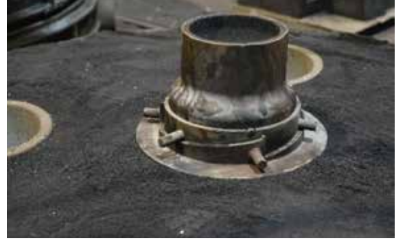
▲ Şekil 5b: kalıbın üstünde kaldırma sistemi
