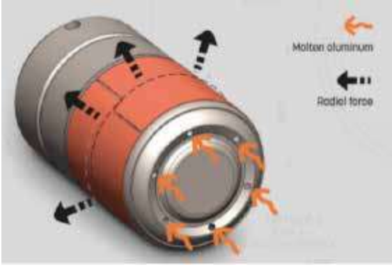
COPROMEC® ring, piston ve hazne arasındaki boşluğu kompanse ederek, hazneyi korur!
