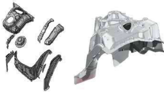
Bir alüminyum döküm parçayla değiştirilen, çelik sac parçalardan yapılmış şok kulesi (Audi 12) Kaynak: Aalen Uygulamalı Bilimler Üniversitesi, Aalen, Almanya
