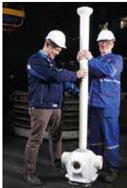
Şekil 4b: Kalıp monte edildiğinde HOLLOTEX Shroud filtre kutusuna gider
