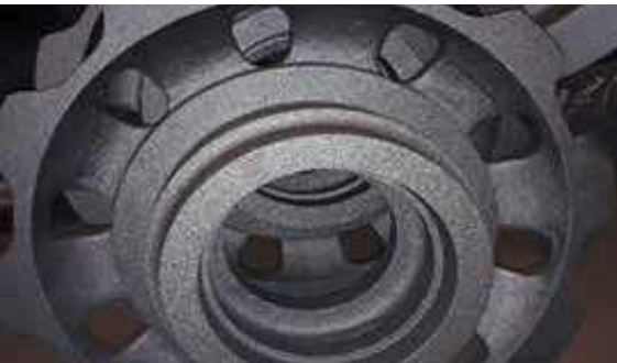
▲ Şekil 12d: Ultrasonik ve MPI kontrolleri sonrası üst derece döküm yüzeyi
