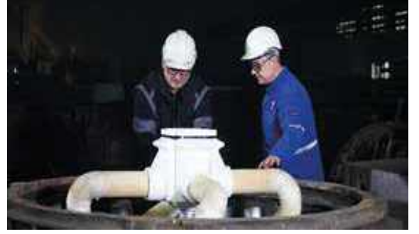
Şekil 5a: Filtre kutusu ve alt derecede çalışan sistem kurulumu
