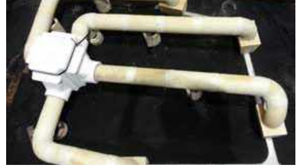
Şekil 16a: HOLLLOTEX Shroud filtre kutusu takılı yolluk sistemi
