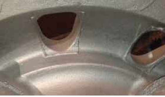
▲ Şekil 12b: Kumlama sonrası üst derece döküm yüzeyi
