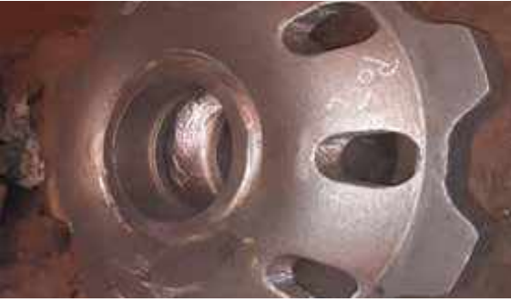
▲ Şekil 12c: Menevişleme sonrası MPI çatlaması
