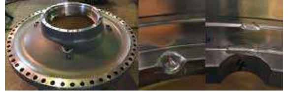
▲ Şekil 14a: Son işlemeden sonraki hatalar
