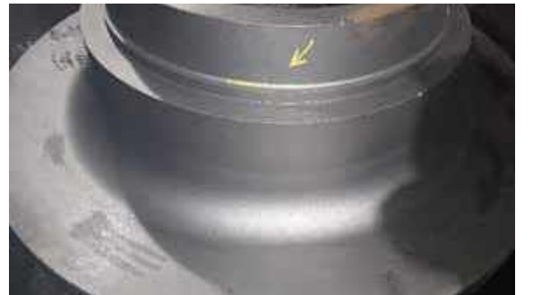
▲ Şekil 14d: Döküm sonrası MPI kontrolü
