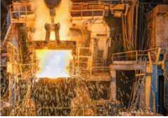
Şekil 2c: Sıvı metal aktarımı, hava sürüklenmesine ve bifilme neden olur
