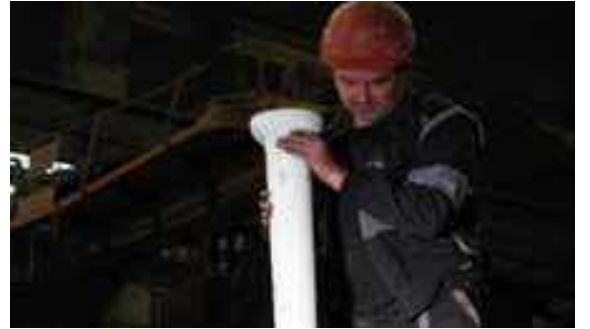
Şekil 6a: Hazırlanmış kalıbın içerisine HOLLOTEX Shroud yerleşimi
