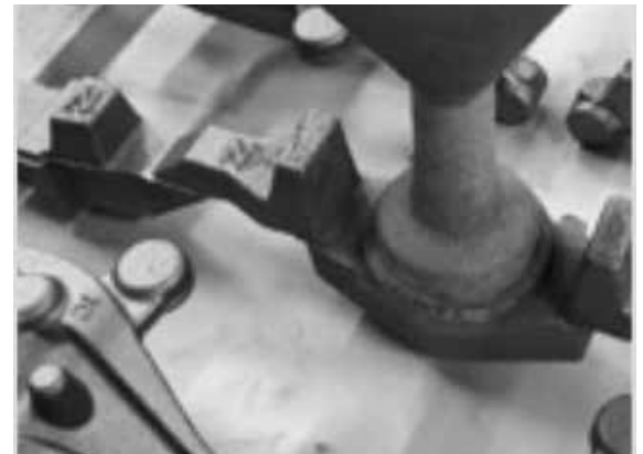
► Şekil 5: Sfero dökme demirden yapılmış direksiyon mafsalları
