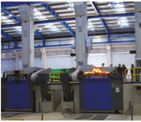
2016 yılında teslimatı yapılan indüksiyon ertitme sistemi, 8,500kW Tri-Trak 3x8000KG Stell Shell'den oluşuyor.
