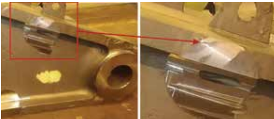
Şekil 17a: HOLLLOTEX Shroud üst derece döküm yüzeyi - yolluk sistemi
