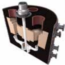
Şekil 7a: HOLLLOTEX Shroud sistemi- nin kalıp içerisine uygulan- ması
