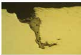
Şekil 1b: Bu kılcal çatlakların dikey kesiti Mag.100x
