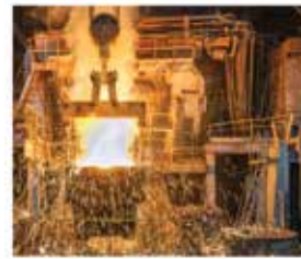
Şekil 2c: Sıvı metal aktarımı, hava sürüklenmesine ve bifilm oluşumuna neden olur
