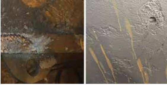
Şekil 15a: Üst yüzeydeki tipik gaz deliği hataları
