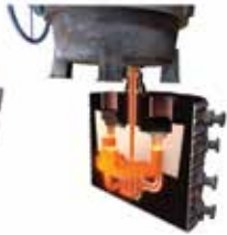
Şekil 7b: Döküm sırasında HOLLLOTEX Shroud sistemi
