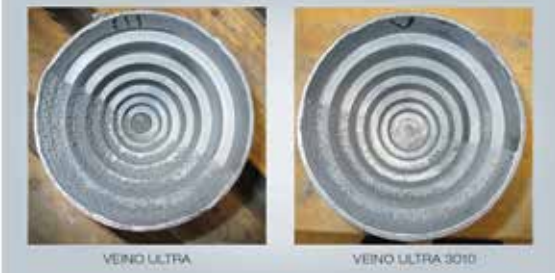
Şekil 3: VEINO ULTRATM ve VEINO ULTRATM 3010 katkı malzemeleri karşılaştırması, yarı boyanmış
