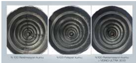
Şekil 4: Veino ULTRATM 3010 kullanılarak yüzey kalitesinin iyileştirilmesi, yarı boyanmış
