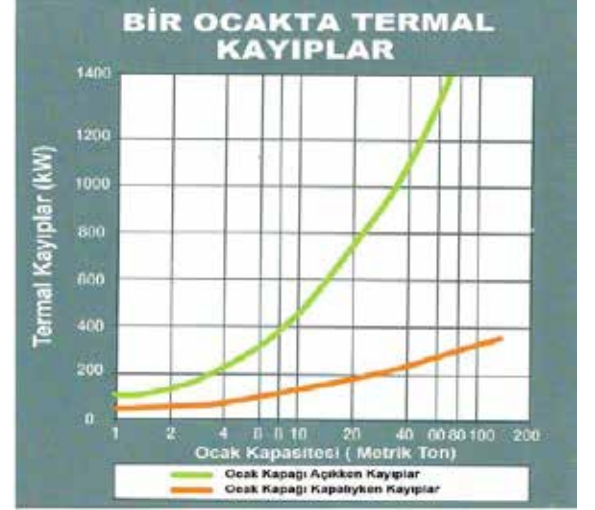
Şekil 9: Ocak kapağı ile Enerji tasarrufu (Ref-2)
