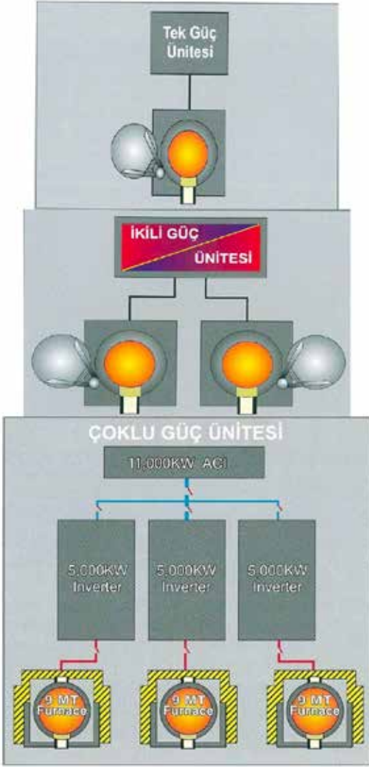
Şekil 2: Tekli, İkili ve Çoklu Güç Üniteli Sistemler (Ref 2)
