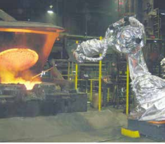
Şekil 5: 6 Platform Robotu ile Otomasyon (Ref 5)
