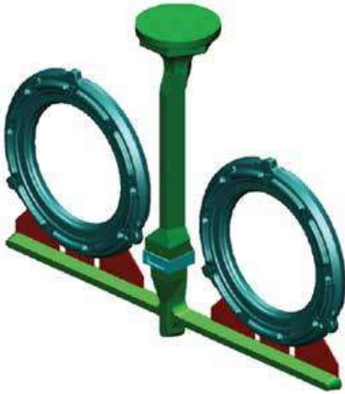
Şekil 2: Geçişe ve eğime sahip düşey yolluklu system
