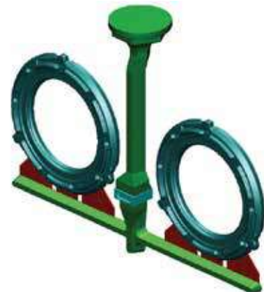
Şekil 1: Normal yolluk sistemi
