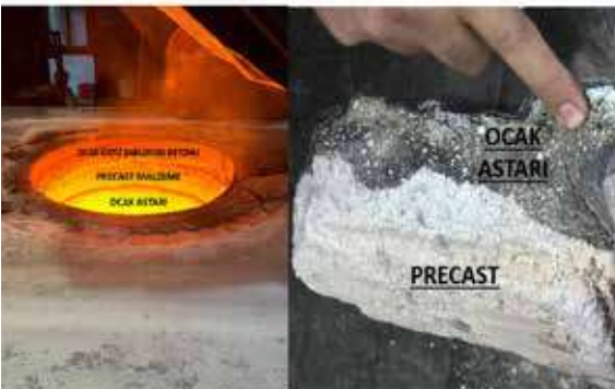
Resim 5: Sinterden Sonra Precast Malzeme ile Ocak Astarının Kaynaşmış Hali ve Ocak Astarı Bozulduktan Sonraki Hali
